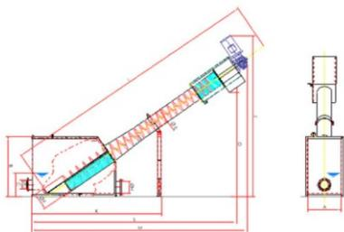
Equipamento combinado para separação de sólidos presente nas águas residuais, que além do transporte efetua a compactação e desidratação. O equipamento é constituído por funil de carga, parafuso transportador e compactador. A zona de filtração pode ser de perfil Johnson (0.25 e 2mm), ou de chapa perfurada (3 a 10 mm)
