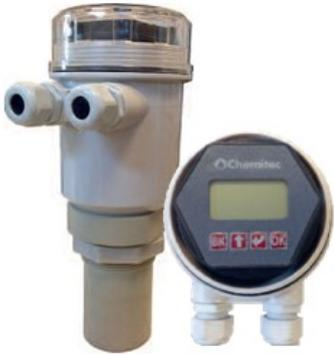
A tecnologia de medição utilizada pelo transmissor de nível METER é a emissão de um pequeno impulso ultrassónico. A onda ultrassónica propaga-se em direção à superfície do produto a ser medido, voltando para trás em direção ao sensor. O intervalo de tempo que decorre entre a emissão e a receção da onda é chamado de tempo de envio e é proporcional à distância medida, e consequentemente ao nível.
